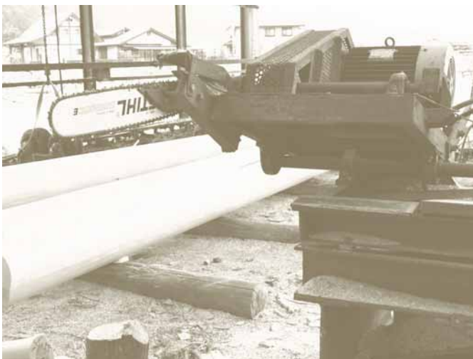
Peeled Tokobashira poles
